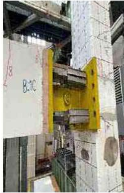
Şekil 24. A1 düğüm noktasının artan yerdeğiştirme aşamalarındaki hasar durumu
