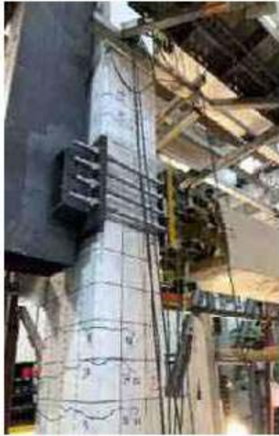
Şekil 25. B1 düğüm noktasının nihai hasar durumu
