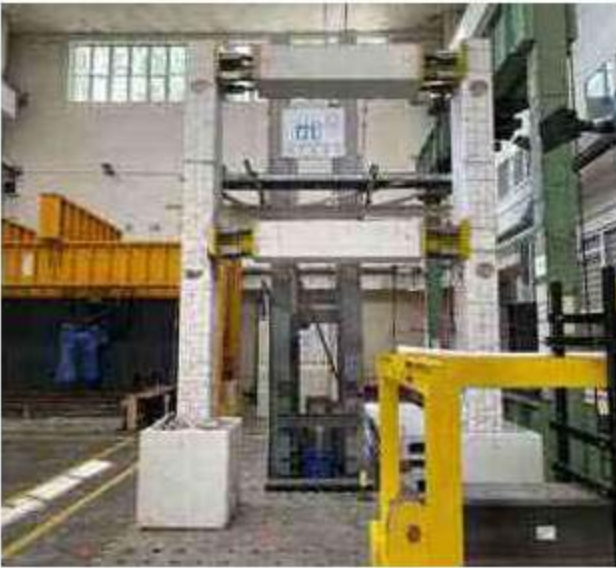
Şekil 23. Deney numunesi ve kolonlarının deney sonundaki durumu
