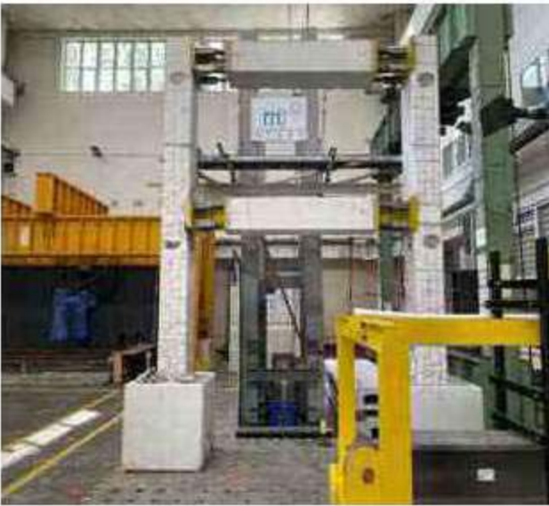
Şekil 23. Deney numunesi ve kolonlarının deney sonundaki durumu
