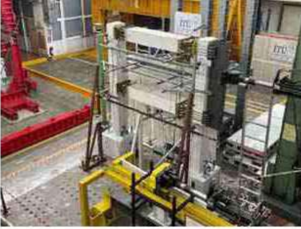
Şekil 22. Deney çerçevesi ve elde edilen yatay yük-yerdeğiştirme ilişkisi
